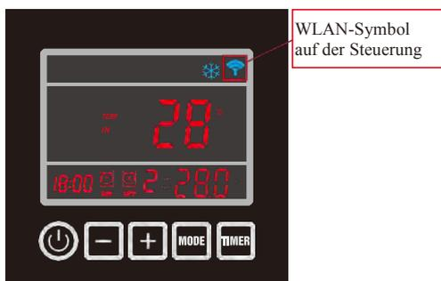
Starten Sie die Wärmepumpe und drücken Sie die Taste „-“ und die Taste „TIMER“ auf dem Display gleichzeitig 3 Sekunden lang, um das WLAN Steuerungsdisplay zu aktivieren. Das WLAN-Symbol blinkt auf und sucht das nächstliegende WLAN-Netz.
